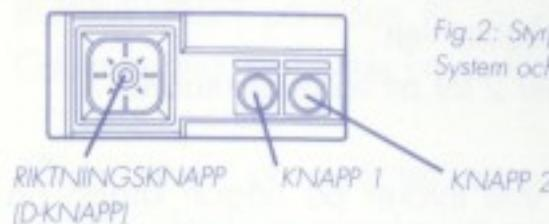
Fig. 2: Styrplattan för Sega Master System och Master System II
