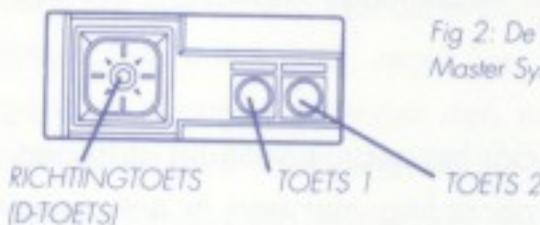
Fig. 2: De controller van het Sega Master System en het Master System II.
