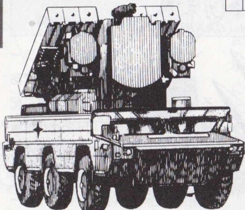
1975年のモスクワ・パレードに初めて現れた、ソ連の全天候型低空防空用自走ミサイル。車体はZIL-167 トラックから開発されたもので、浮航性を持つ。射程は1,600~12,000mで、指令電波に誘導され最終段階では赤外線ホーミングとなる。
