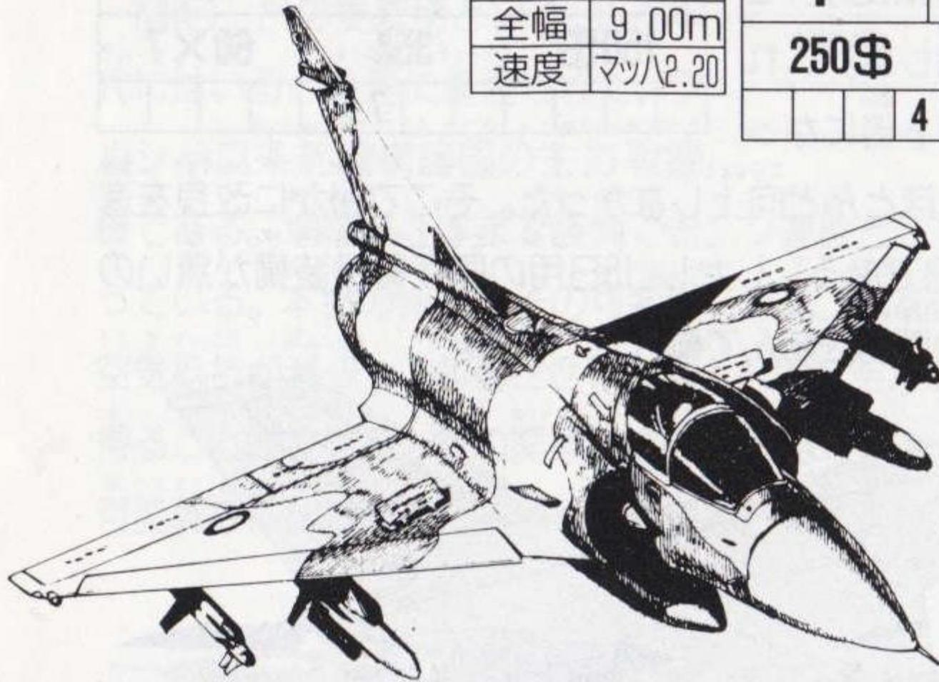
CCV技術により、空中機動力は大幅に改善されている。しかしデルタ翼のため、対地支援には向いていない。
