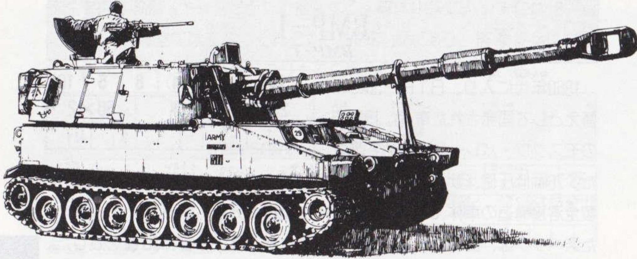
1950年代後半に開発が始られ、米陸軍のみならず世界で最も使用されている155mm自走砲である。自走砲の第二世代と呼ばれるこの車両の特徴は、最初から専用の設計の車体を持ち、完全密閉の全周旋回の砲塔と優れた機動性である。A3型は、A2型にFCSの自動化、射程の延長などの改良を行ったタイプである。
