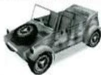
**WV 82 Kubelwagen (Moteur : 24cv/3000 tpm, 4-cyl, 985cc / Poids : 725 kg / Vitesse maximale : 80 km/h / 4 places, 3 zones de tir) :**
